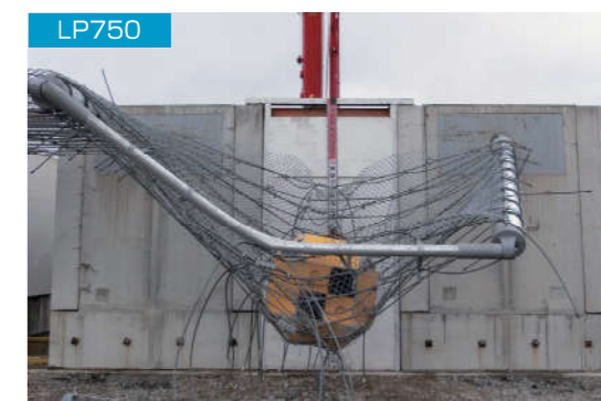
LP750 衝突エネルギー 753kJ 衝突速度 25.0m/s
