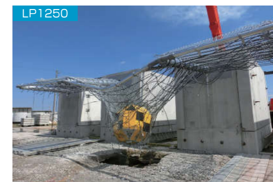
LP1250 衝突エネルギー 1255kJ 衝突速度 25.0m/s
