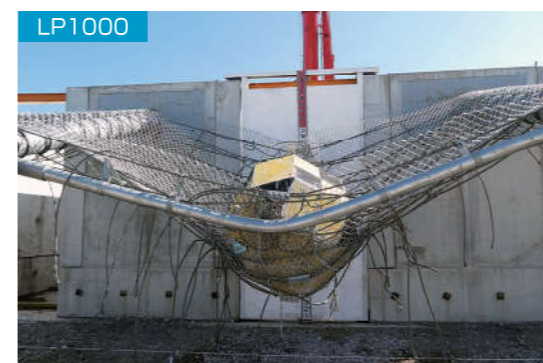
LP1000 衝突エネルギー 1004kJ 衝突速度 25.0m/s
