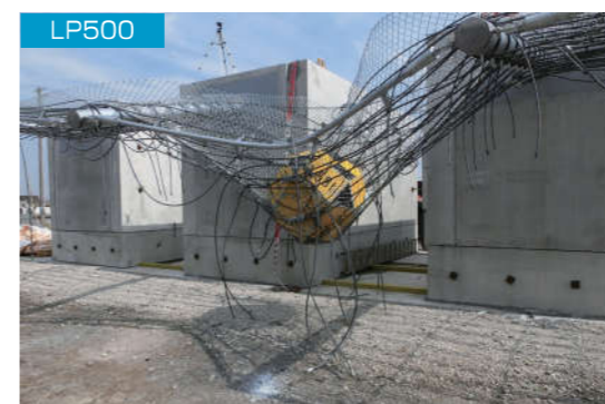
LP500 衝突エネルギー 503kJ 衝突速度 25.2m/s
