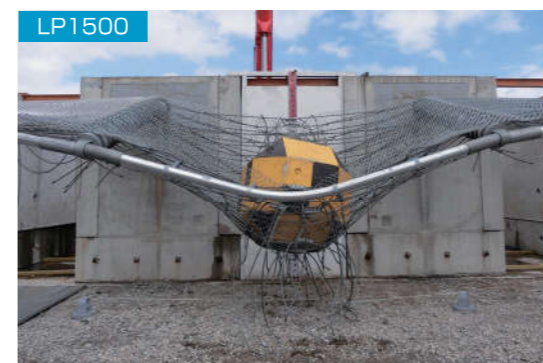
LP1500 衝突エネルギー 1506kJ 衝突速度 25.0m/s
