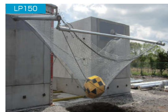
LP150 衝突エネルギー 160kJ 衝突速度 25.0m/s
